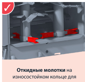
Валы Ø 900 мм и спирали 10 мм. Централизованная смазка валов. Оцинкованные боковые дефлекторы с острыми краями для резки шпата. (A) Износостойкое кольцо в основании валов.
